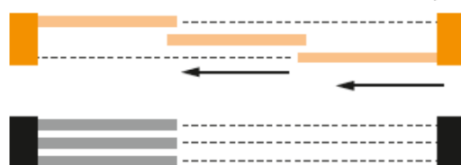
3 vantaux sur 3 rails - ouverture 2/3
