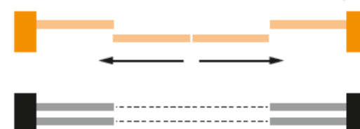
4 vantaux sur 2 rails - ouverture 1/2
