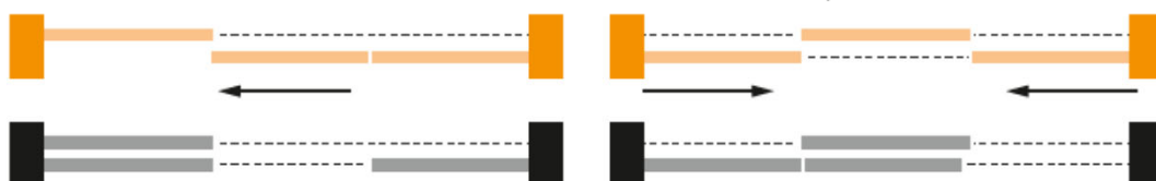
3 vantaux sur 2 rails - ouverture 1/3
